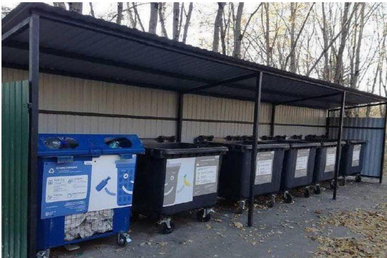
*Рисунок 4.20 Вариант обустройства контейнерной площадки*
