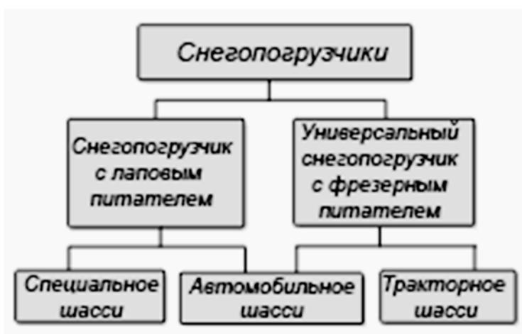
Рисунок 6.12 Классификация снегопогрузчиков
