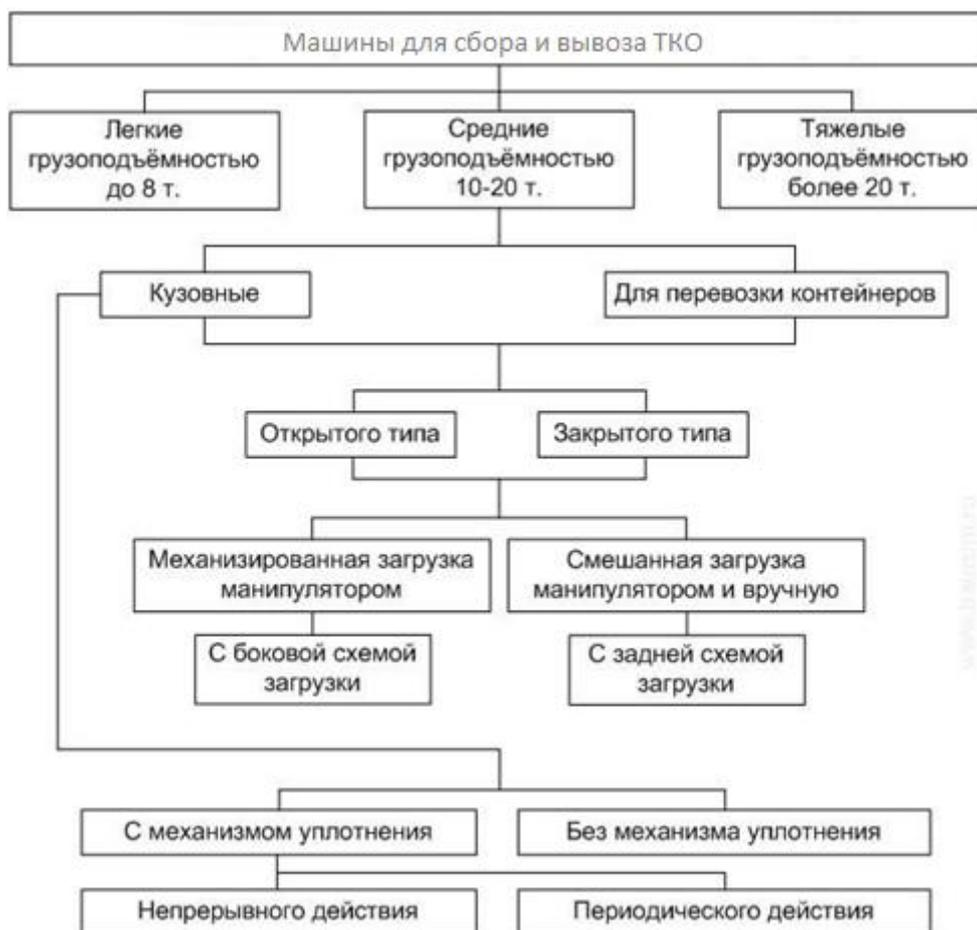
Рисунок 4.27 Классификация машин для сбора и вывоза ТКО
