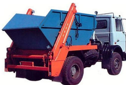
Рисунок 4.31 Бункеровоз МКС-3501 на шасси МАЗ-5551А2
