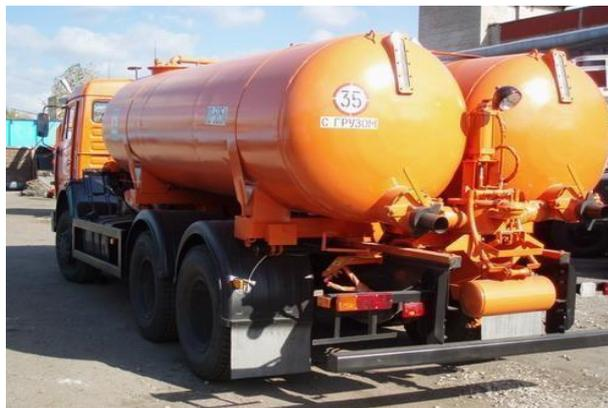
Рисунок 5.4 Вакуумная машина КО-505А на шасси КамАЗ-65115-71
