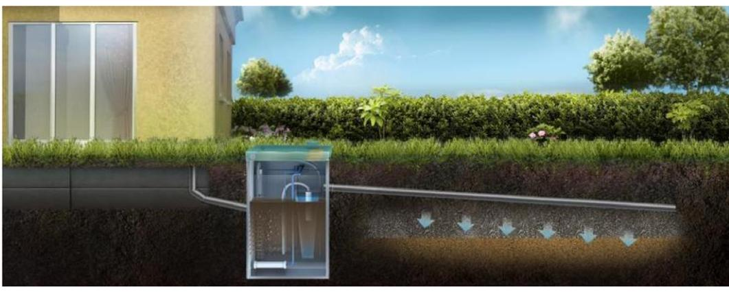
*Рисунок 5.7 Отвод очищенной воды на поле фильтрации или в дренаж*
