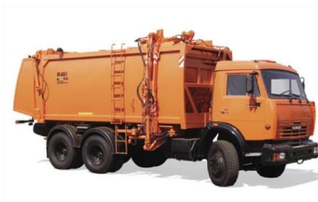
Рисунок 4.30 Мусоровоз с боковой загрузкой КО-440-5 на базе шасси КАМАЗ 65115
