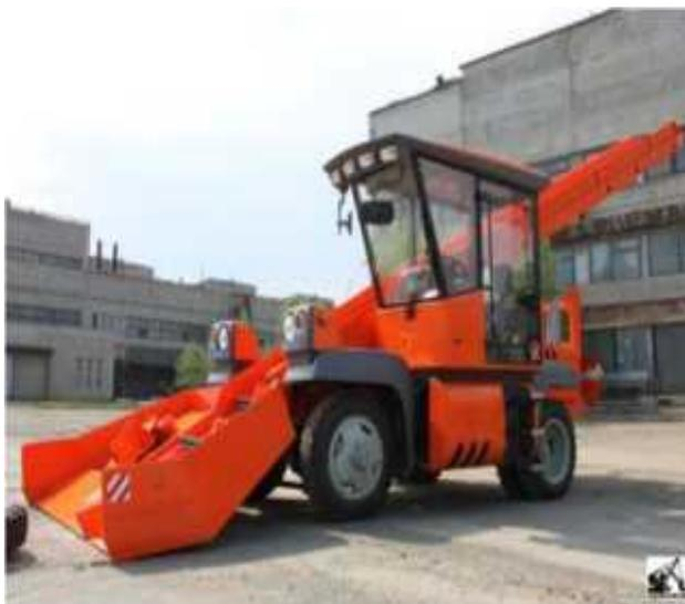
Рисунок 6.15 Лаповый снегопогрузчик КО - 206
