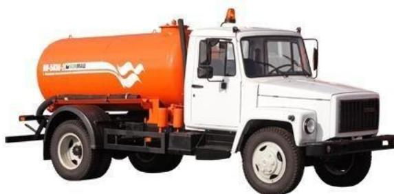
*Рисунок 5.3 Вакуумная машина КО-503В-2 на шасси ГАЗ-3309*
