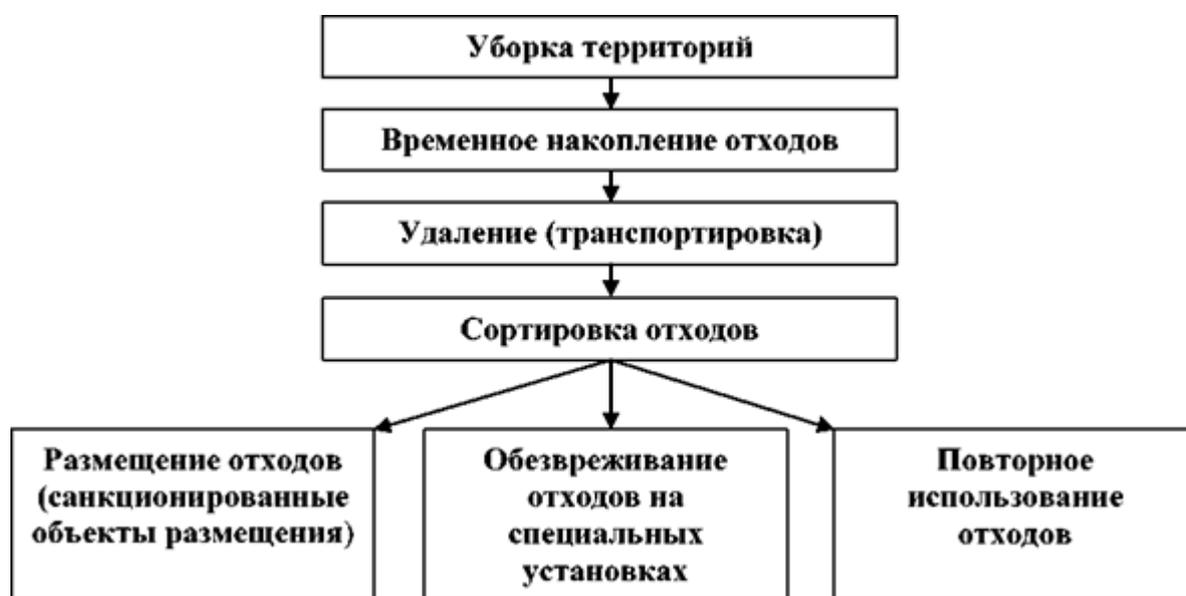
*Рисунок 3.1 Графическое изображение схемы очистки территории Городского округа*
